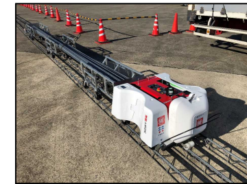
鉄筋運搬ロボット
