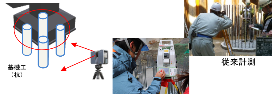
TLSを用いた場所打ち杭の出来形計測
