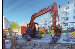
日立建機・バッテリー駆動式ショベル
