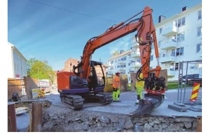
日立建機・バッテリー駆動式 ショベルZE85 (◆)
