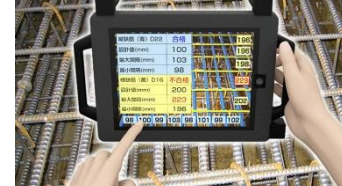
清水建設・リアルタイム自動配筋検査システム
