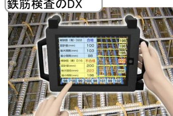
清水建設・リアルタイム自動配筋検査システム
